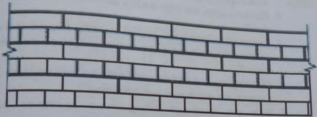
Рис. 65. Однорядная (цепная) система перевязки швов
