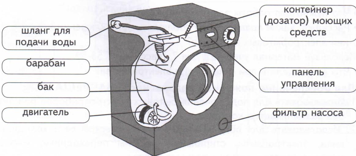
Покажи на стиральной машине в школе и дома её части: верхнюю крышку, переднюю стенку, дверцу, шланг для залива воды, дозатор моющих средств, бак, фильтр насоса, барабан, панель управления.
