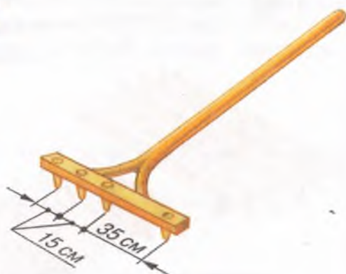
Рисунок 41. Зубовой маркёр для разметки ленточного посева гороха
